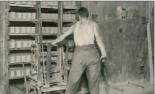
Befüllung der Trockner mit Handschiebebühne und handbetätigtem Absetzwagen um 1920
