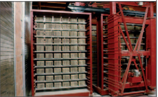
Automatisches Trocknerwagensystem um 2000
