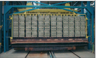
Beladener Tunnelofen- wagen beim Zufahren der trockenen Roh- linge auf Bereitstell- gleisen neben dem Tunnelofen um 2004
