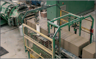
Extrudieren von Mauerziegeln um 2004
