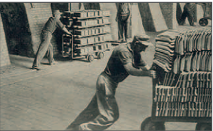
Setzer beim Zufahren der trockenen Rohlinge im Gang vor dem Ringofen um 1950
